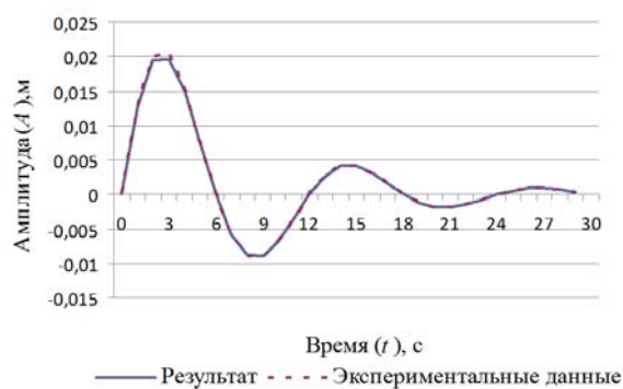
Рисунок 3.1 – Колебания многопустотных плит ПК 63.15.8АТ800АТ-8 под действием внешней нагрузки
